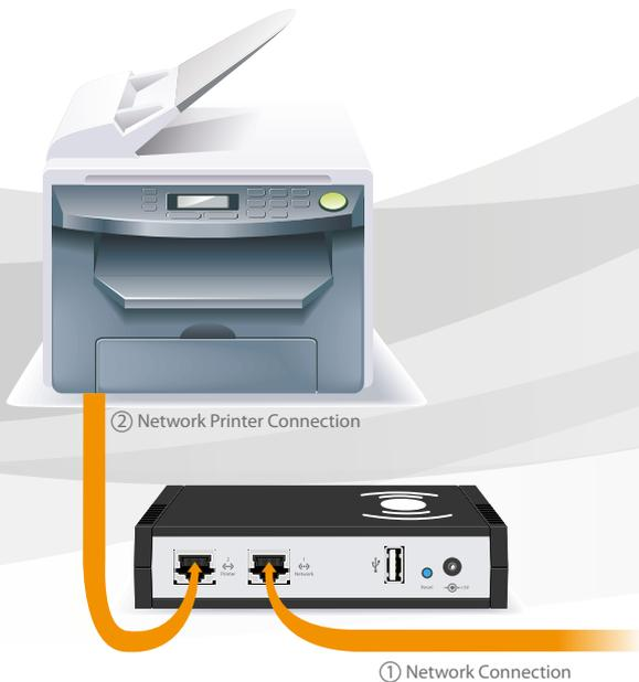
Der ThinPrint Reader ist druckerherstellerunabhängig und kann transparent zwischen Drucker und Netzwerk geschaltet werden. Diese Art der Einbindung lässt die bestehende Infrastruktur, zum Beispiel Output Monitoring Systeme, völlig unbeeinflusst.
